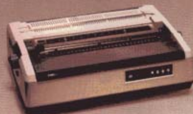
Facit 4565 Imprimante à roue. 40 CPS. Qualité courrier. Utilise des roues à caractères standards. Circuits LSI pour une grande fiabilité.
