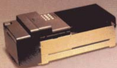
Facit « Telexpunch ». Perforateur de ruban télex. Branchement simultané sur une ou deux machines à écrire électroniques ou systèmes de traitement de textes. Conversion de codes et perforation de texte en « clair » en standard.
