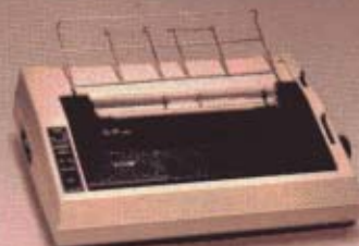
Facit 4510 Imprimante matricielle. 80 colonnes 120 CPS. Trois modes d'insertion du papier. Divers fonts de car. et graphique par points ou blocs (semi-graphique).
