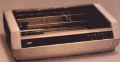
Facit 4525/26 E Imprimante matricielle 80/132 colonnes. 140 à 285 CPS - 165 CPS à 10 car./pouce. 1 à 5 copies. Divers fonts de car. et graphique par points.
