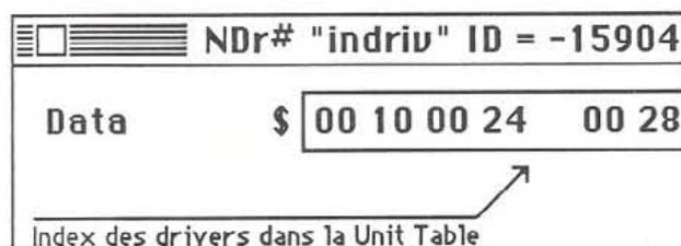
Dans la configuration ci dessus, “Corner light” examine le *Disk Driver* et les drivers d'*AppleTalk* (indications des drivers sur 16 bits).
