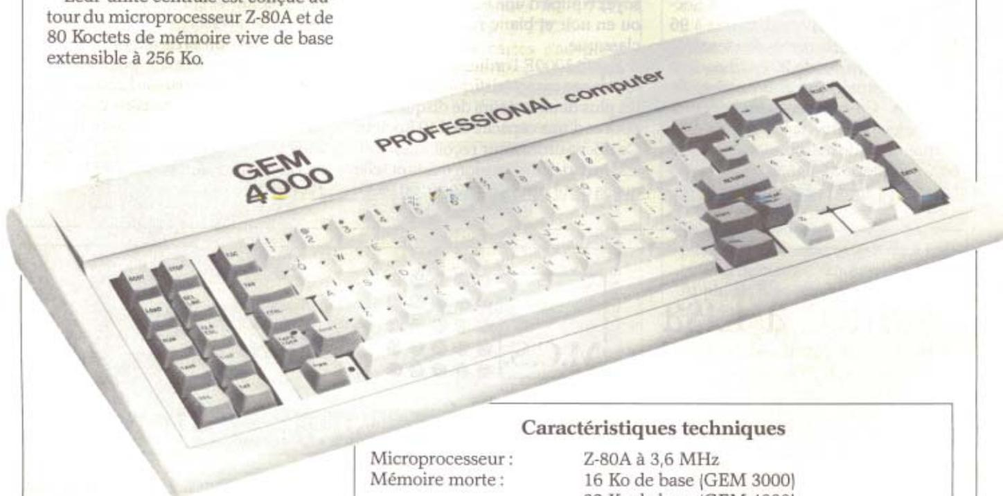
16 couleurs sont incorporées en standard sous une résolution graphique de 256 x 192 points. Le GEM 3000 comporte également un générateur de sons à 3 voies sur 8 octaves et un lecteur de cartouches de jeux Coleco. Le GEM 4000 intègre quant à lui un générateur de sons à 6 voies sur 8 octaves et un modem.
